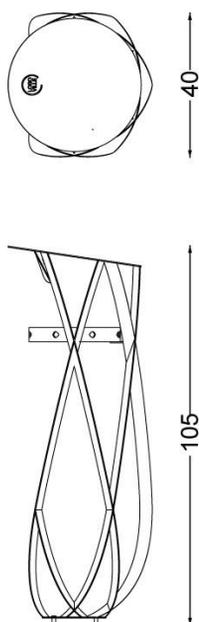
**Pose.** La pose peut se faire fixée au sol par 3 ancrages, fixée en drapeau contre un mur ou un poteau ou sur socle. Des kits de fixation au sol, en drapeau et un socle sont disponibles en accessoires. Sur demande la pose peut être assurée par nos soins.
