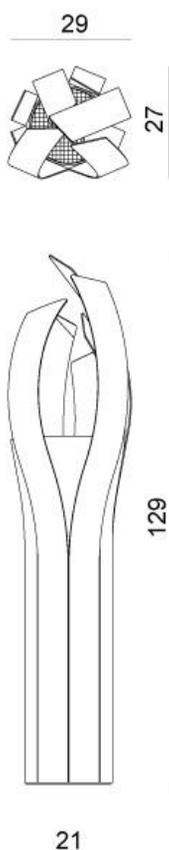
**Pose.** Dimensions : hauteur 129 cm, diamètre moyen 28 cm. Flamme peut être posé de trois manières, sur socle posé au sol, sur socle fixé par quatre vis, sur cheville chimique centrale sans socle visible. Un kit de fixations au sol et un socle sont disponibles en accessoires. sur demande, la pose peut être assurée par nos soins.
