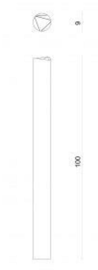
**Pose.** encombrement : 100 cm x 9 cm. La pose peut se faire fixée au sol par 3 ancrages ou sur scellement. Des kits de fixation au sol sont disponibles en accessoires. Sur demande la pose peut être assurée par nos soins.
