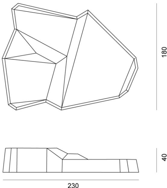
**Pose.** La pose peut se faire fixée au sol par 4 ancrages ou sur pieds. Des kits de fixation au sol et un socle sont disponibles en accessoires. Sur demande la pose peut être assurée par nos soins. Dimensions: Assise : H 40cm, L 230 cm, l 180 cm.
